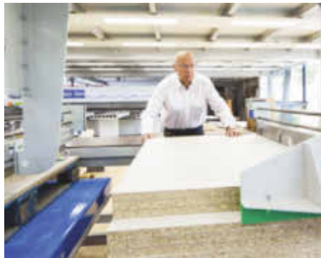
/ Die Stapelposition wird in Breite und Tiefe über die Anschlagschienen definiert.
