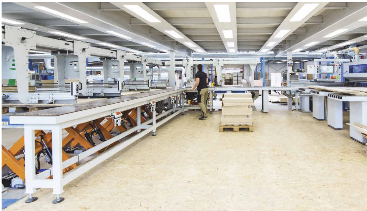
/ PolyPoint: Luftkissenbahnen verbinden sechs Stapelstellen (vier links, zwei hinten) mit der Plattenaufteilsäge (rechts).
