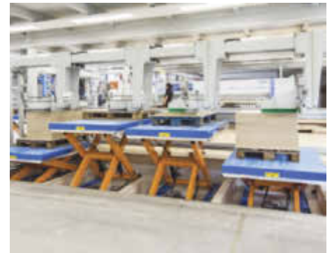
/ Die Scherenhubtische verfahren automatisch, gesteuert über eine Höhentastung per Lichtschranke.
