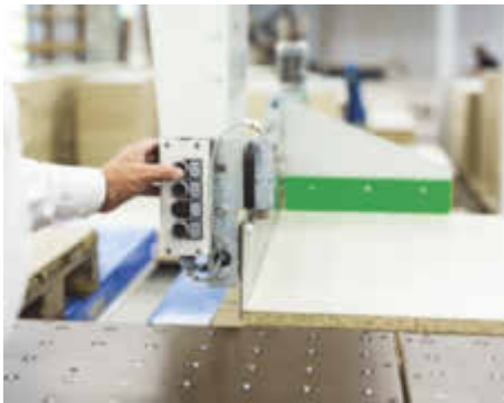
/ Die Anschlagschiene lässt sich einfach per Knopfdruck auf das gewünschte Maß verstellen.
