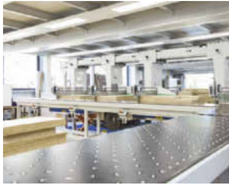
/ Die Plattenpakete lassen sich sehr leicht und kräfteschonend über die Luftkissentische bewegen.
