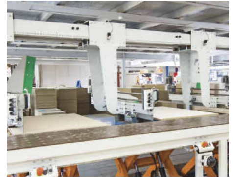
/ Dank automatischer Absenkfunktion können die Platten eben auf die Stapel geschoben werden.
