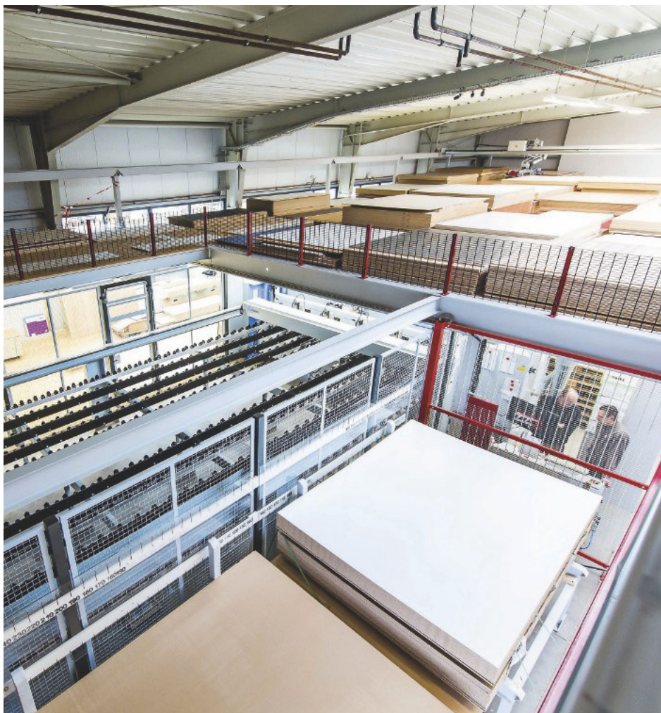
/ Das automatisierte Plattenlager über zwei Etagen zeigt, wie sich wenig Raum effektiv nutzen lässt. Dabei setzt Becker-CNC auf die luftige Freifläche im oberen, selten ausgenutzten Hallenbereich.
